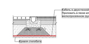
Установка лотка в покрытие тротуара из брусчатки
