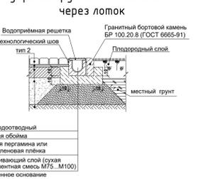
3. Тротуара из брусчатки с тротуаром из а/б через лоток
